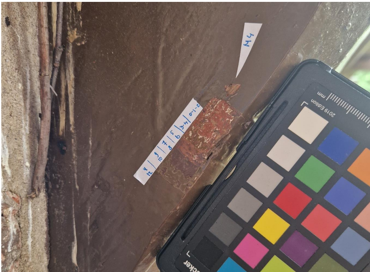
Figuur 39. Kleurtrap op de balk onder de kapel met locatie van dwarsdoorsnede M4.
